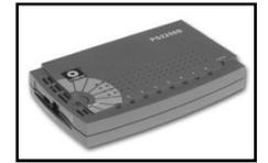
Ein **Switch** arbeitet wie eine Bridge auf der Schicht 2 des OSI-Schichtenmodells und ist im Vergleich dazu in der Lage, eine Lastverteilung der unterschiedlichen Verbindungen bereits innerhalb eines Netzwerk-Segementes zu steuern und damit die Bandbreite zu verbessern.
