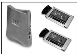
Die drahtlose Vernetzung (**Wireless LAN**) stellt eine weitere Verbindungsalternative dar. Hierzu verwendet man spezielle Netzwerkkarten, die mittels Antennen und so genannten **Access Points** die Verbindung im Funkfrequenzbereich von 2,4 GHz herstellen. Die Übertragungsbandbreite liegt nur bei 10 MBit/s. Der Vorteil besteht darin, dass keine baulichen Maßnahmen erforderlich sind. Die Reichweite ist jedoch begrenzt. Die Kosten sind im Vergleich zur Kabelkomponente noch vergleichsweise hoch.
